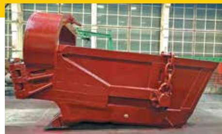
Изготовление ковшей ЭШ-20/90
