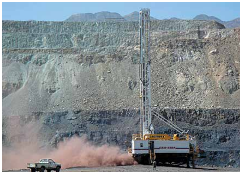
Рисунок 1. Буровой станок СБШ-270А на карьере Sarchesmesh
